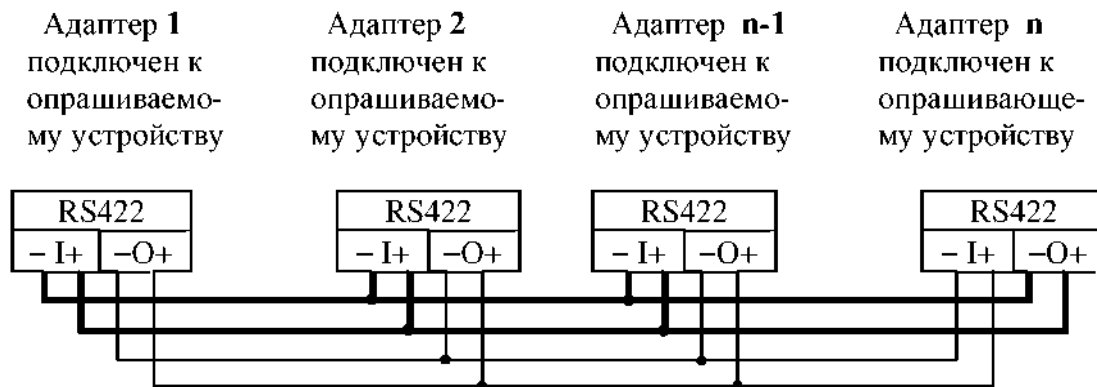
Рисунок 1 - Схема многоточечного соединения
