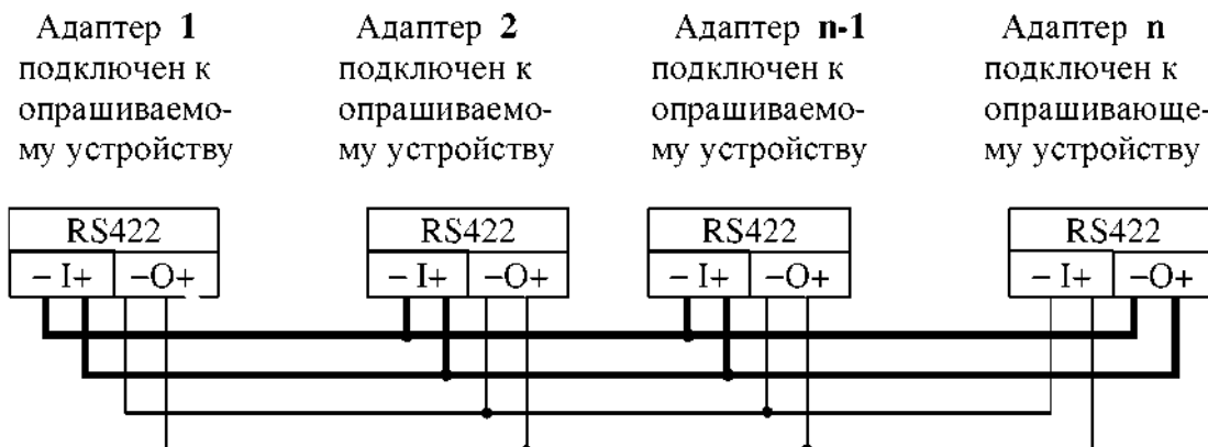
Рисунок 1 - Схема многоточечного соединения
