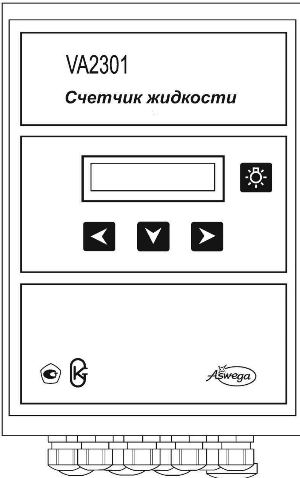
Рисунок 5 - Вид спереди вычислительного блока
