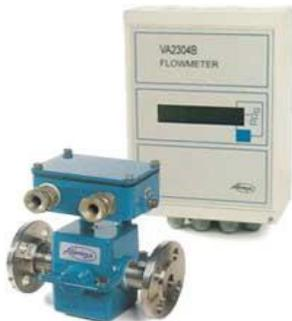
Предназначен для преобразования величины расхода жидкости в выходные электрические сигналы: частотный, импульсный и токовый, а также измерения объёма проходящей через первичный преобразователь невзрывоопасной жидкости нарастающим итогом и за установленный промежуток времени.
