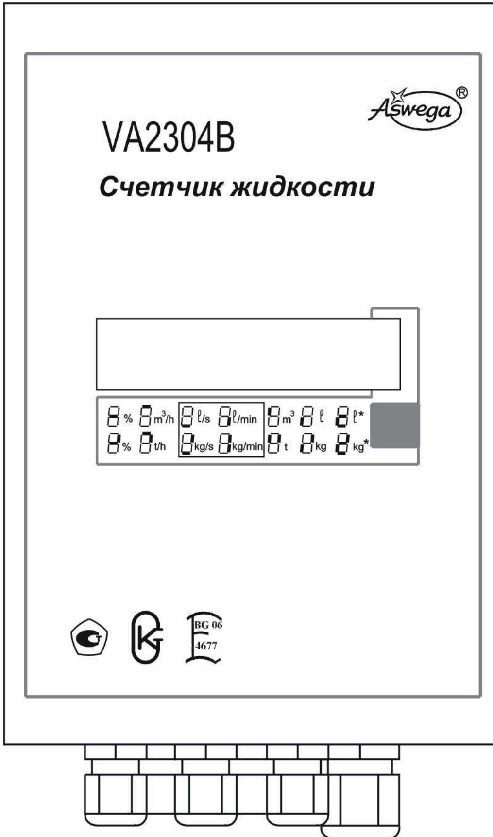
Рисунок 8 - Вид спереди вычислительного блока настенного исполнения
